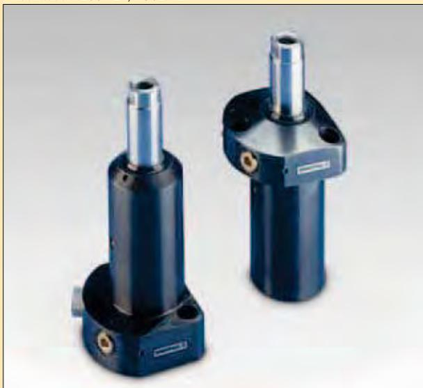
**Cilindros hidráulicos de atracção utilizam a pressão hidráulica para segurar as peças em um dispositivo. A haste, guiada internamente, mantém a orientação durante o ciclo completo de fixação, eliminando a necessidade de um guia externo. Rosca interna na ponta da haste aceita vários acessórios feitos sob medida, para ajudar no processo de fixação.**
