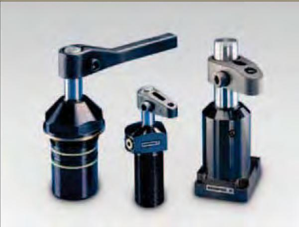
Os cilindros giratórios Enerpac permitem a fixação e posicionamento da peça sem obstruções. O êmbolo da haste e o braço de fixação giram 90 graus, quer no sentido horário quer no sentido anti-horário, depois descem numa distância adicional para fixar a peça. Com a liberação da pressão de fixação, o braço gira 90 graus, para a posição original, permitindo a remoção e o posicionamento de uma peça nova.
