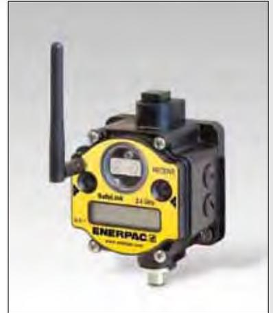
As unidades "RECEIVE" do Sistema de Segurança podem abastecer as saídas, utilizando o protocolo padrão Modbus RTU RS-485. Esta saída usa conector de 5 pinos na unidade "RECEIVE". Caso haja preferência por protocolo Ethernet, uma PONTE ETHERNET está disponível para conversão de Modbus RTU R-485 para ETHERNET IP ou Modbus TCP/IP.
