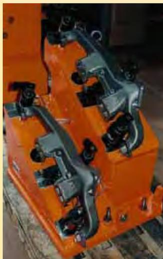
■ Cilindros Giratórios Collet-Lok® MPTL-100 e MPTR-100 são usados para fixar firmemente estes coletores de escape.
