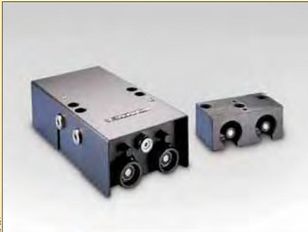
▶ O sistema de conexão automática permite o acoplamento e o desacoplamento de circuitos hidráulicos "palletizados". Este sistema elimina a interferência direta de um operador, oferecendo liberdade às mãos e o funcionamento seguro do processo. Sistemas típicos incluem uma estação base, localizada na estação de carga/ descarga e acionando um ou mais coletores montados nos "pallets".
