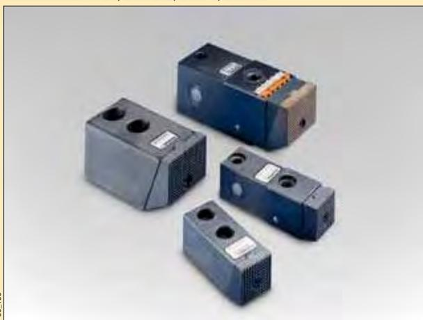
**Cilindros tipo Morsa Enerpac** são projetados para permitir a usinagem da parte superior da peça sem obstrução. Movimentos horizontal e vertical independentes atingem altas forças no sentido lateral e para empurrar para baixo, sustentando firmemente a peça contra a mesa de usinagem ou dispositivo. As forças para empurrar para baixo são, aproximadamente, 33% da força lateral de fixação.
