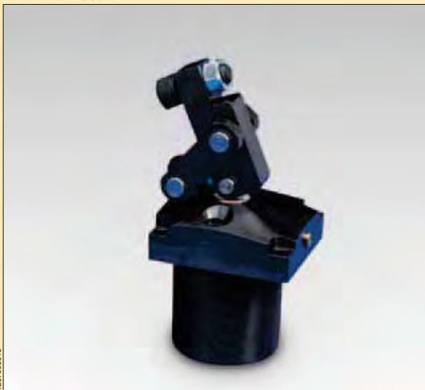
**▶ Grampo de Articulação** permite o carregamento da peça, sem obstruções, e maior força de fixação. A haste do cilindro hidráulico é estendida para fornecer a força de fixação, e retorna, permitindo a remoção da peça.
